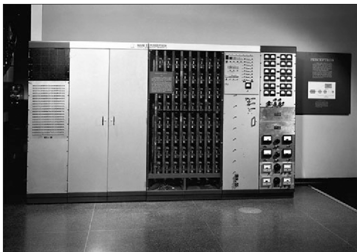
Рис. 1.5. Алгоритм перцептрона первоначально был реализован в виде электронного устройства; на приведенной фотографии изображен компьютер Mark I, созданный в 1958 году специально для реализации перцептрона (публикуется с разрешения Смитсоновского института)
