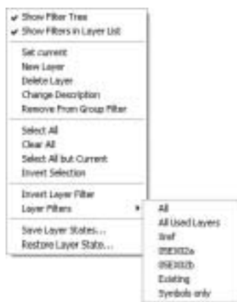
Рис. 5.16. Контекстное меню диспетчера Layer Properties Manager предоставляет доступ к функциям редактирования и возможностям быстрого управления слоями
