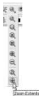
Рис. 5.6. Групповая кнопка Zoom содержит вложенное меню с наиболее часто используемыми командами масштабирования
